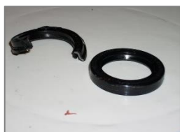
径向油封损坏
